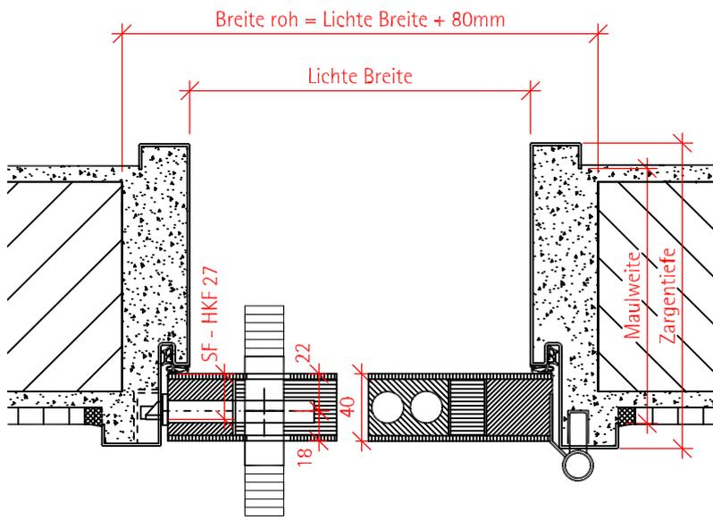
Mauer beidseitig roh + ALBA Vollgipswände: Maulweite = Steinmass + 5mm
