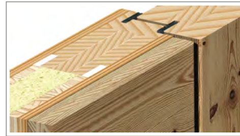
Detail: Standard-Türblatt Rohling mit Massiv-Altholz Applikation
