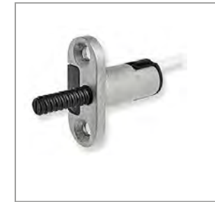
RIEGELSCHALTKONTAKT RSK1 Im mittlere Schließblech eingebaut. Wird durch den mittlere Riegel ides Türschlosses betätigt. Rückmeldung: Tür manuel oder mechanisch abgeschlossen!
